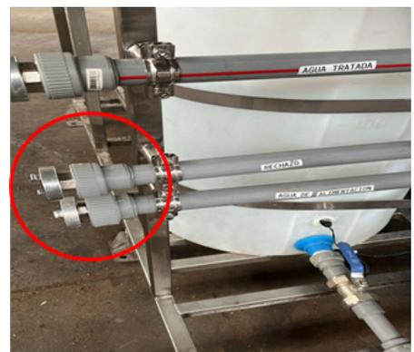
5. Abrir la válvula de desagüe del sistema decantador para eliminar los sólidos acumulados.
